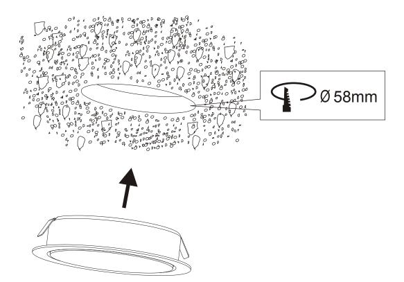
Installation får endast utföras av behörig elinstallatör. Installation should be carried out by your local electrician. Die Installation durch einen Fachmann vornehmen lassen. L'installation doit être effectuée par un installateur qualifié. We raden aan om de installatie door enn erkend vakman te laten doen. Debe ser instalado por un electricista cualificado. L'installazione deve essere effettuata da un elettricista qualificato. Asennuksen saa tehdä vain pätevä sähköasentaja.
